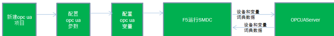
图 7-5-1 互联互通 opc ua 配置流程
