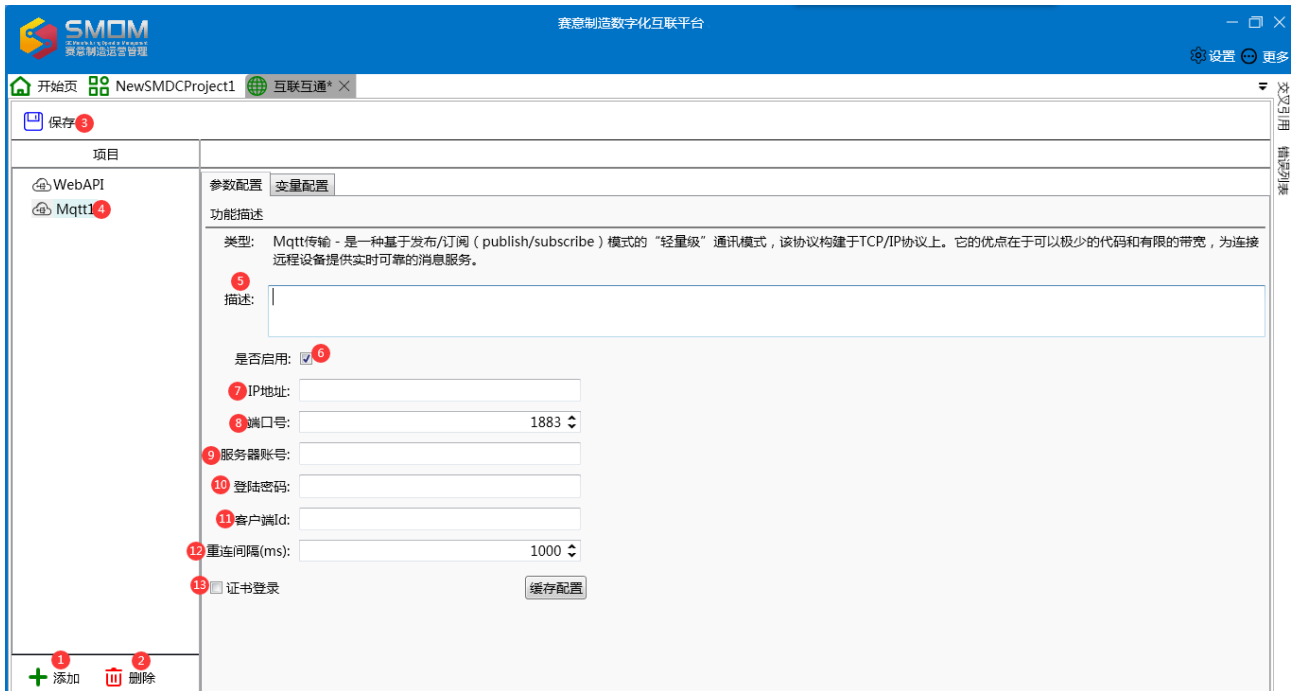
图 7-3-4 配置 Mqtt 参数
